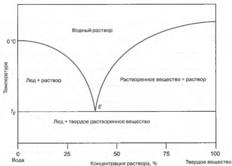
Рисунок 1 – Диаграмма состояний, схематически показывающая поведение двухкомпонентного раствора с эвтектической точкой E и эвтектической температурой T_E
