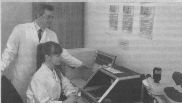
Определение тонны шерсти на приборе OFDA-2000 аспирантом Н.А. Новгородовой под руководством декана факультета, профессора Н.И. Белика
