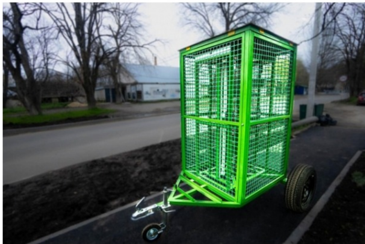
Ловушки манят саранчу ультрафиолетом. Фото: Министерство энергетики, промышленности и связи Ставропольского края
