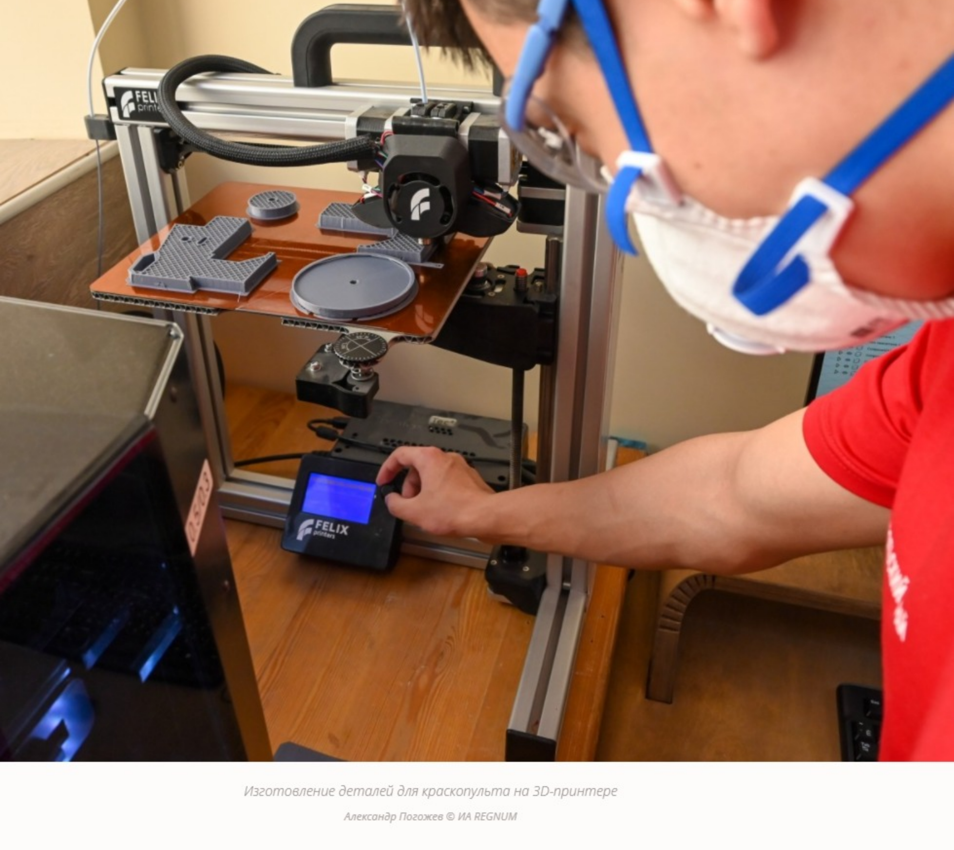
Изготовление деталей для краскопульта на 3D-принтере Александр Погожев © ИА REGNUM
