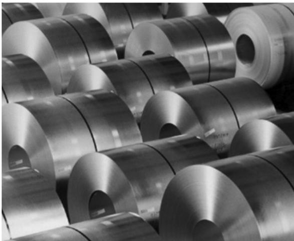
Рисунок 2 – Рулоны электротехнической стали
