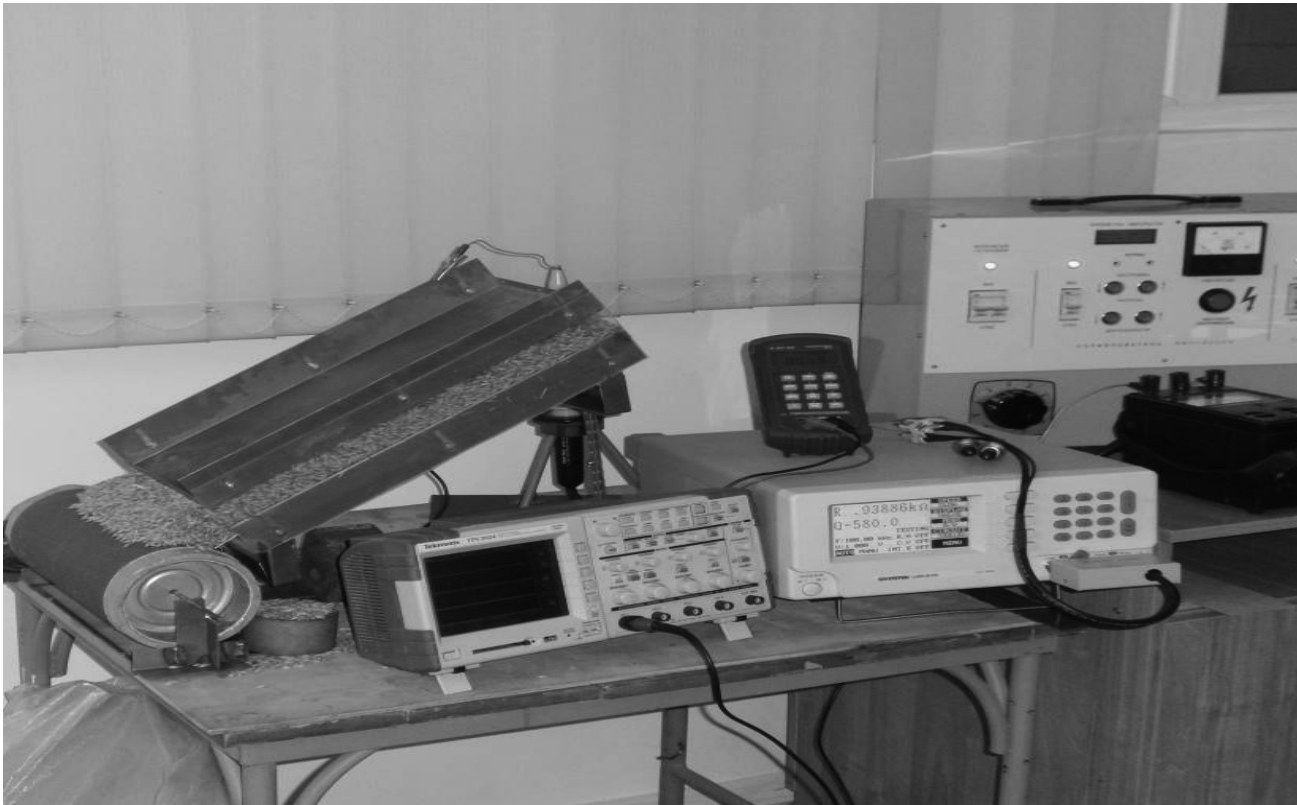
Рисунок 1 – Лабораторная установка для обработки семян ИЭП
