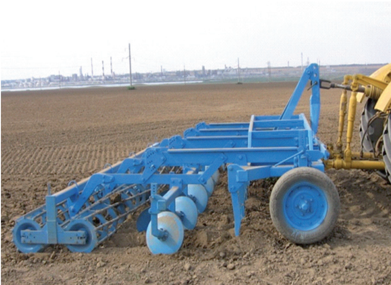
Рисунок 2 – Культиватор «Аллигатор V-5» для стерневой и предпосевной обработки почвы
