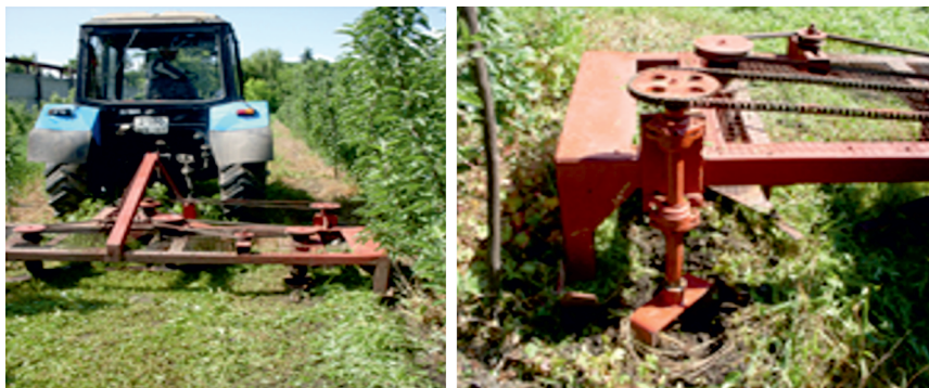
Общий вид установки для ухода за почвой в интенсивном садоводстве
