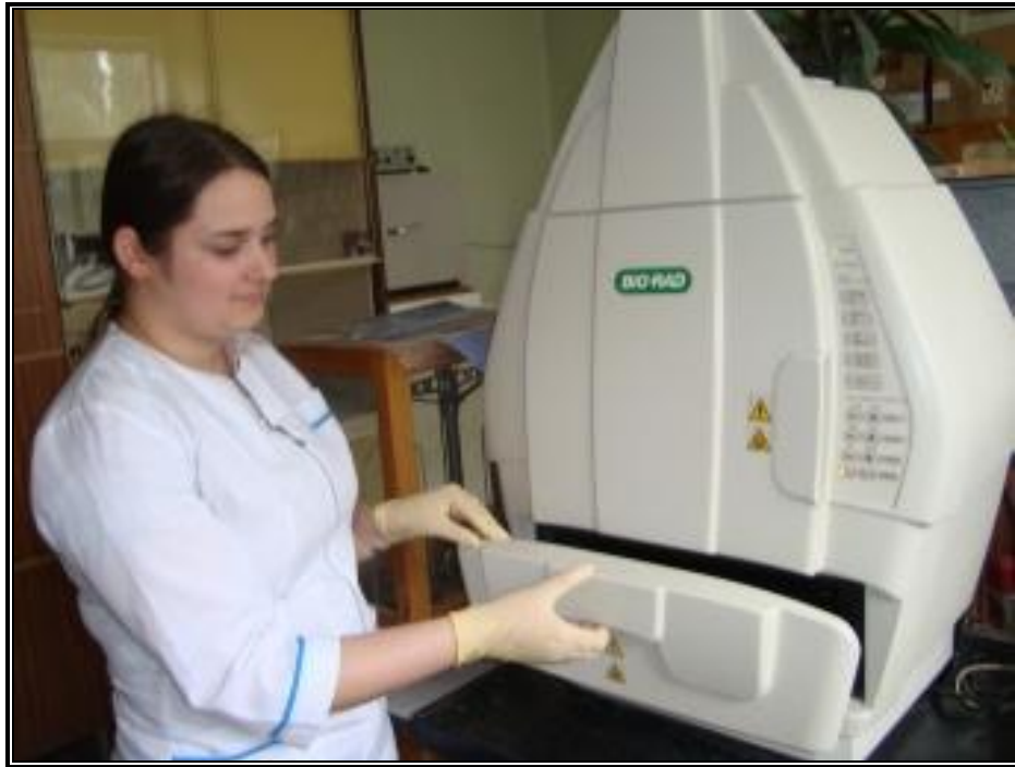
Рисунок 8 - Заключительный этап ПЦР анализа по выявлению гена p53 у куриного эмбриона с помещением агарозного геля с пробами на фильтр трансиллюминатора Gel Doc
