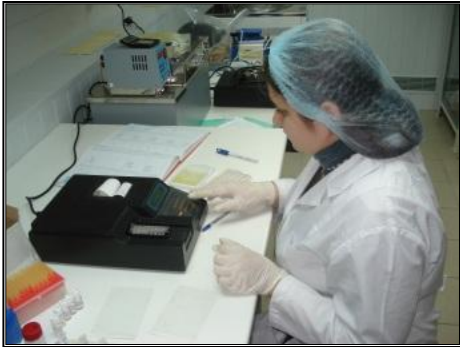
Рисунок 6 - Определение уровня половых гормонов у куриных эмбрионов разного пола с помощью иммуноферментного анализа на микростриповом фотометре Stat fax 303 Plus
