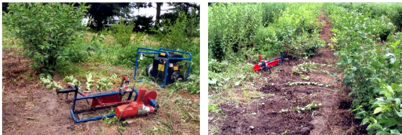
Рисунок 10 – Экспериментальное устройство для отъема отводков от маточного куста в работе
