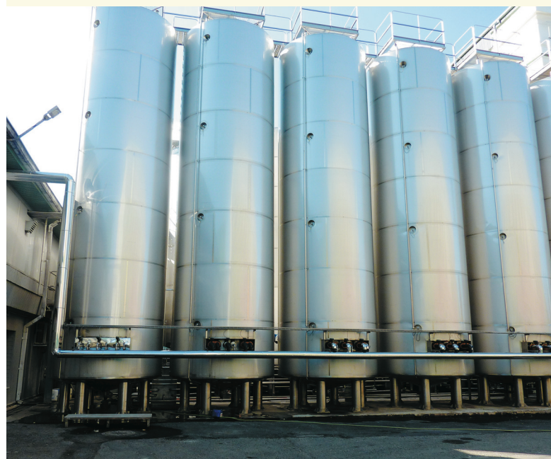
В ЗАО «Абрау-Дюрсо» в таких акратофорах (аппаратах для получения виноматериалов резервуарным способом) происходит процесс удаления винного камня.
