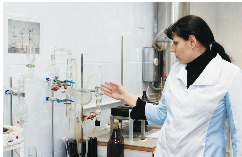
На фото слева: Титриметрическая установка для проведения химического анализа продукции ЗАО «Ставропольский пивоваренный завод».
